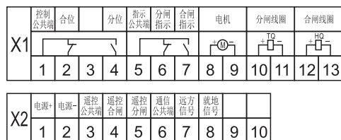
背板接线图 1. 用于断路器柜和负荷开关熔断器组合柜
